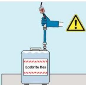
4. Faça a ligação do produto ao sistema de dosagem de roupa com as lanças de sucção adequadas. Prestar atenção à rotulagem correcta do tubo, de acordo com a cor da etiqueta. Evitar misturar as lanças de aspiração entre produtos diferentes.
